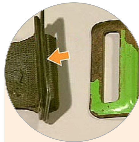
Bouclerie de fermeture déformée et corrodée
