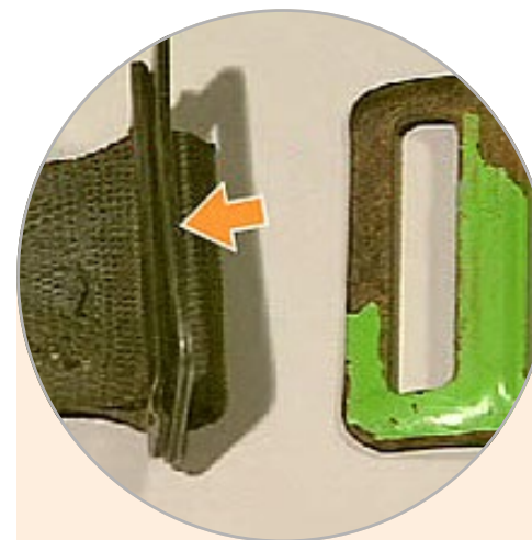
Bouclerie de fermeture déformée et corrodée
