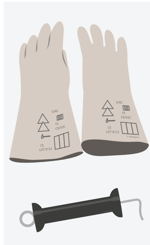
Gants isolants et poignée isolante
