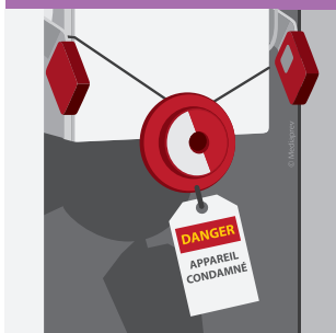
Exemple de condamnation d'une armoire
