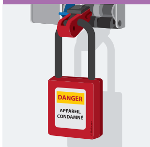
Exemple de condamnation sur disjoncteur
