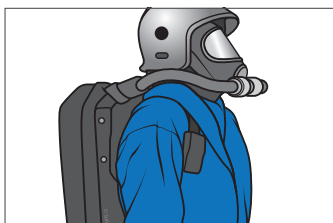
Appareil autonome à circuit fermé
