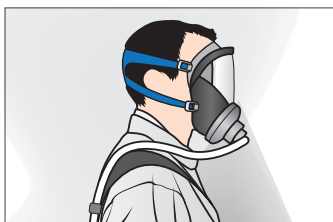
Appareil non autonome à adduction d'air comprimé
