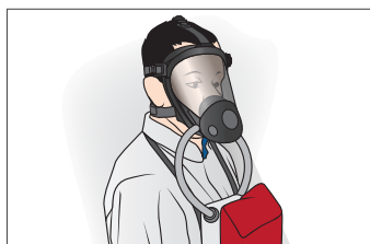
Appareil autonome à circuit fermé à génération d'oxygène
