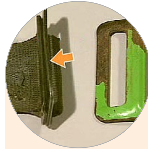
Bouclerie de fermeture déformée et corrodée
